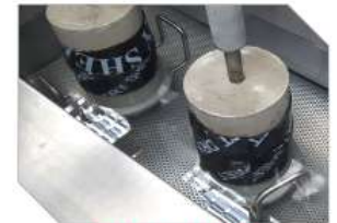
파손 및 투수 없음
